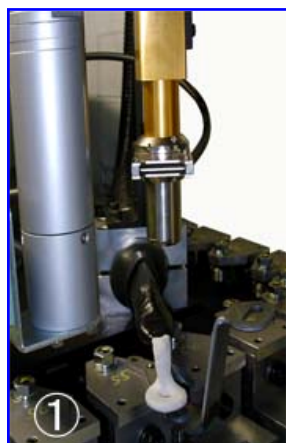
① マニュアルコントロールシャフトの高周波熱処理装置 (放射温度計使用によるPID温度制御)
