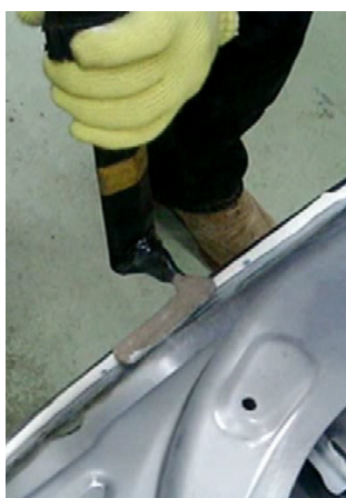
自動車ドアの樹脂硬化加熱
