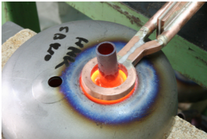
圧縮機 アッパーシェルのロー付け
