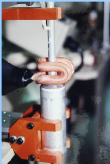
↑アキュレータ ロー付 側面写真
