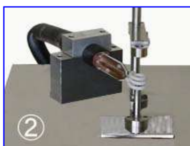
②アルミパイプの高周波焼なまし装置 (設定、記憶した加熱チャートによるアルミパイプの焼なまし)
