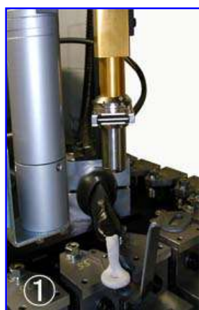
①マニュアルコントロールシャフトの高周波熱処理装置
