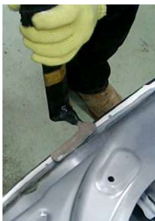
■自動車ドアの樹脂硬化加熱
