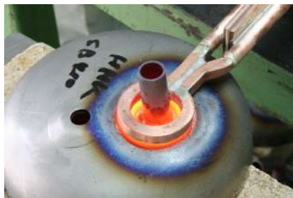
■圧縮機 アッパーシェルのロー付け
