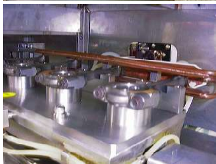
■自動車エンジンピストンピンコンロッド焼き嵌め
